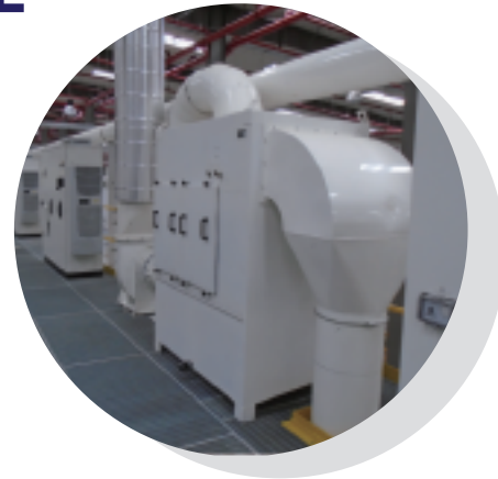
• 铝质罐体拉伸机和修边机的 内部真空传输和油雾过滤系统
